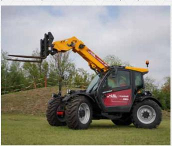
L'Agri Farmer 34.7 GD, macchina più compatta e leggera rispetto all'Agri Plus utilizzato nel 2020, è equipaggiato con un'unica pompa a cilindrata fissa e, rispetto al modello precedentemente testato, beneficia ancora maggiormente dei vantaggi offerti dal sistema ALS.
